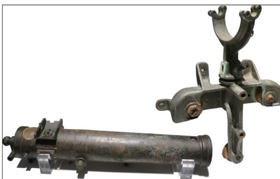
图 2 加特林机枪出水并经保护处理后的状态
